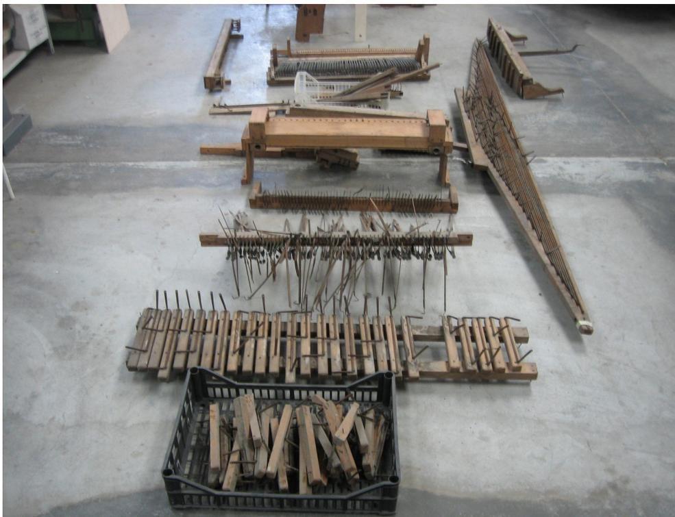
Panoramica delle componenti della trasmissione meccanica il laboratorio
