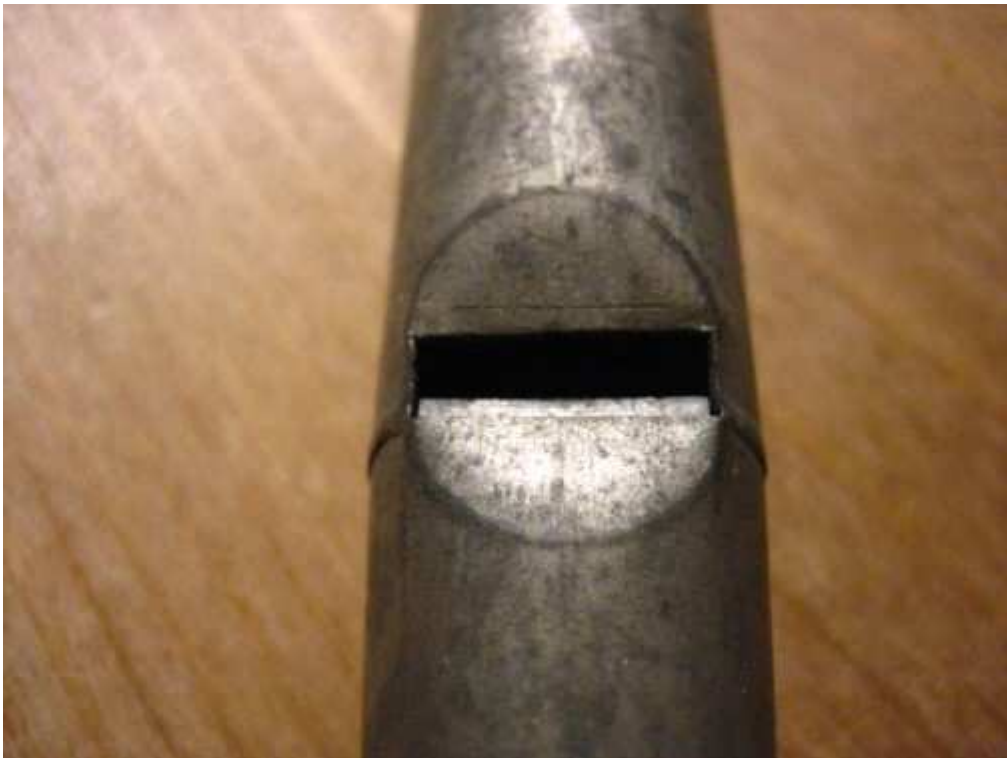
03 particolare della bocca di una canna Bonatti
