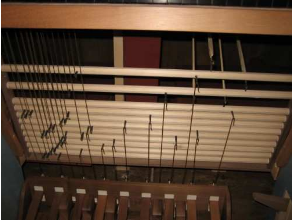
14 Catenacciatura in legno per l'unione tasto – pedale ricostruita
