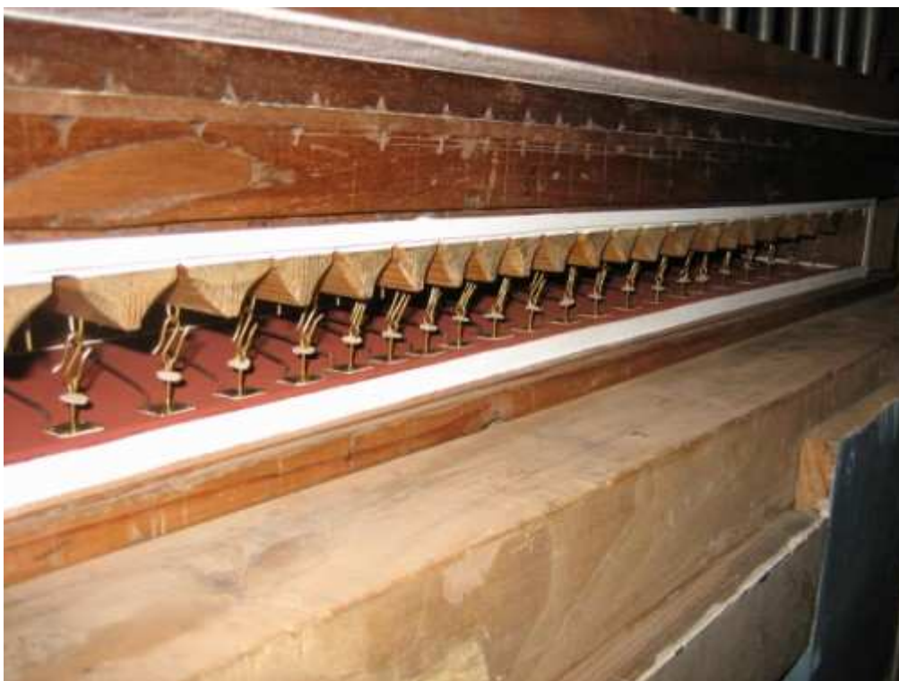
13 Somiere al termine dei lavori (la secreta con i ventilabri)
