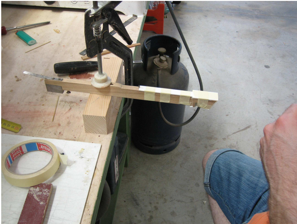
Incollaggio delle coperture
