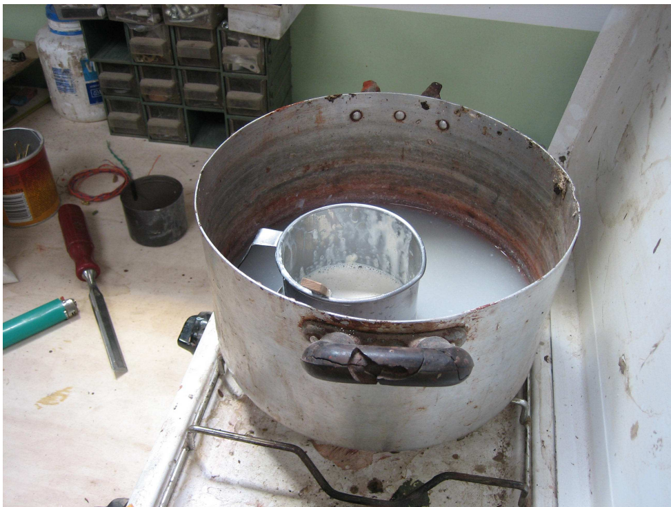
Colla a caldo specifica fusa a bagno Maria, per l'incollaggio delle coperture
