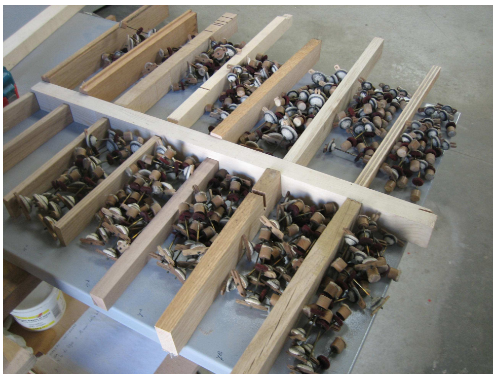
Somieri: valvole coniche, smontaggio e rinnovo delle guarnizioni e dei tamponi
