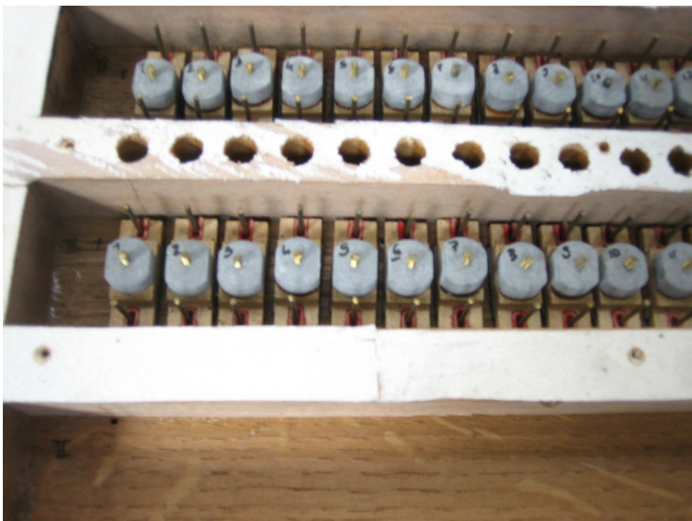
06 Consolle: somierini di carica delle tastiere particolare delle valvole con i pesi in piombo
