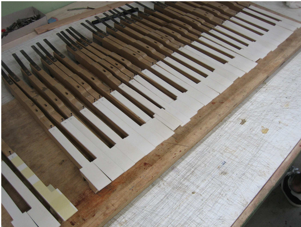
Consolle: ricostruzione delle coperture dei tasti diatonici in osso di bue
