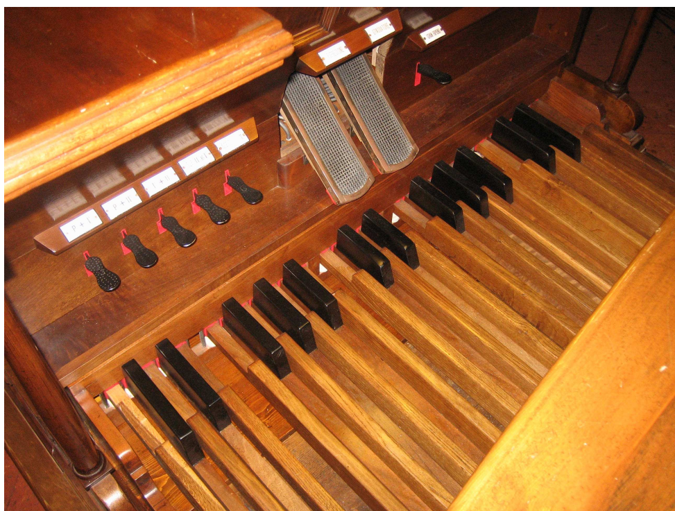
Pedaliera, pedaletti ad incastro e staffe del Crescendo ed Espressione dopo il restauro
