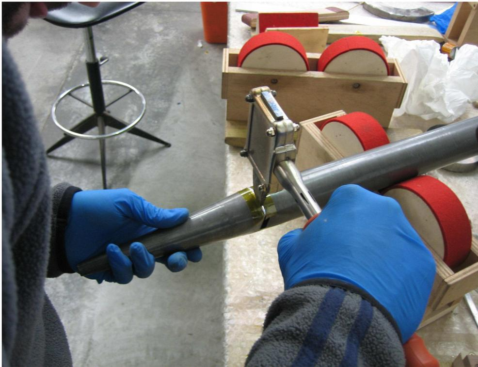
013 Saldatura del piede e del corpo di una canna labiale
