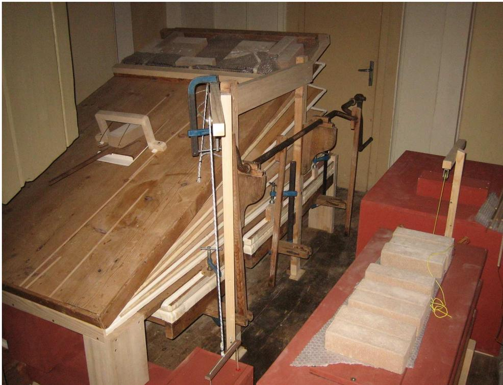
015 Il mantice primario con l'elettroventilatore durante il montaggio
